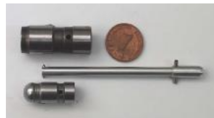
Parallelitäts-Auswertung an Steuerkolben Toleranz 2.0 µm
